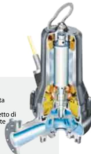
nel **sondino di conduttività sempre in camera olio**, disponibile anche nella versione ATEX (*patent pending*) come unicità tra i prodotti presenti sul mercato; in caso di rottura della prima tenuta, invia il segnale d'allarme immediatamente al quadro, si può così procedere alla riparazione evitando che il liquido pompato superi lo sbarramento costituito dalla seconda tenuta. Il motore elettrico è sempre protetto.
